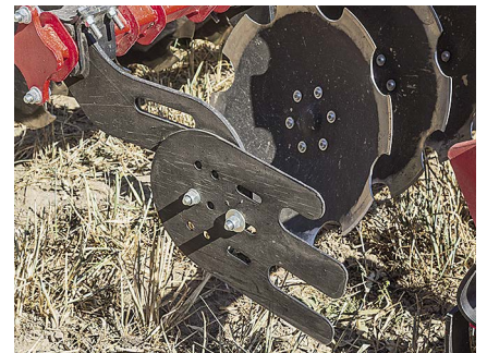
Seitliche Leitbleche begrenzen den Erdstrom nach außen. Auf Wunsch gibt es alternativ Scheibenseche als Begrenzungswerkzeuge.
