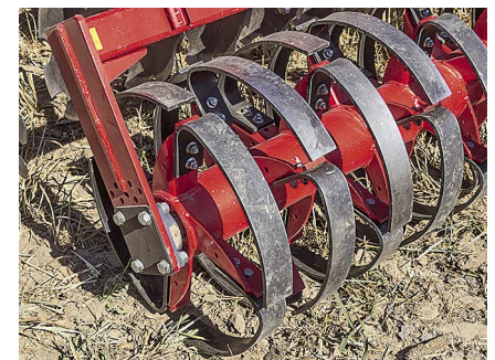
Das Walzenprogramm ist vielfältig, hier eine 600 mm große Federstempelwalze.
