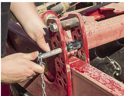
Die Arbeitstiefe lässt sich an jedem Packerarm über einen Bolzen im Lochraster abstecken.
