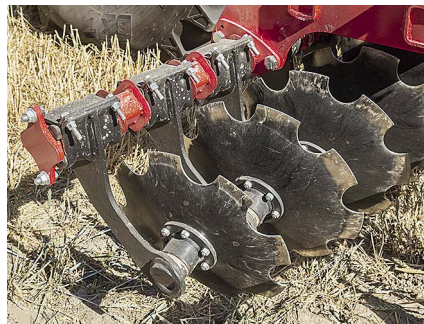
Maximal lassen sich 560 mm große gezackte Hohl­scheiben ordern. Die Scheibenlagerungen sind wartungsfrei. Fotos: Tovornik
